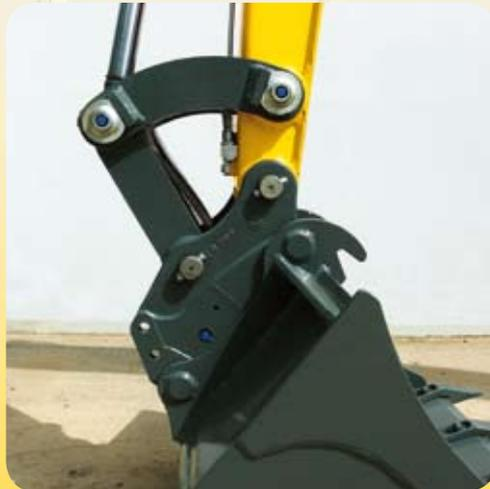
El sistema de cambio rápido hidráulico EASY LOCK actúa de manera óptima sobre la cinemática de las excavadoras compactas Wacker Neuson, y desempeña un papel fundamental en la mejora de los procesos de trabajo: acercarse a una herramienta, acoplarla y cerrarla automáticamente. Gracias a su pequeña altura, los ángulos de desplazamiento hacia dentro y hacia fuera del balancín permanecen intactos. Una contribución de enorme importancia a un plan de trabajo mejorado.
